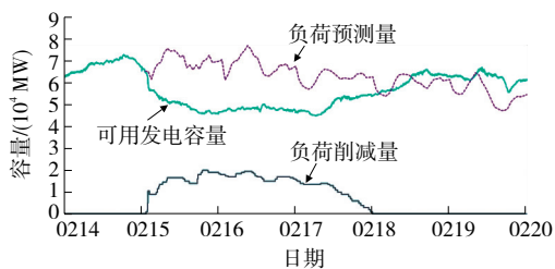
图 6 可用发电容量、负荷预测量及负荷削减量
