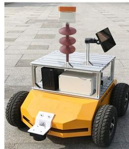
图1 电磁环境智能移动监测装置
