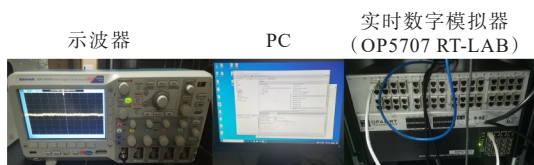
图 13 RT-LAB 实时仿真平台
