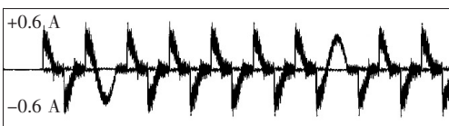
图 9 相地电容 30 \mu\text{F} 配网发生 14.5 k \Omega 电阻接地的 镰刀波与锯齿波相间的相地增量电流
