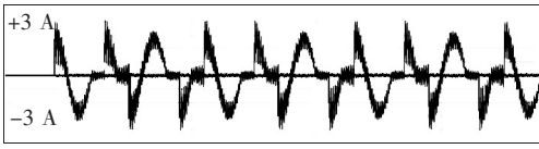
图 6 相地电容 115 \mu\text{F} 配网发生 4 k \Omega 电阻接地的 镰刀波与锯齿波相间的相地增量电流
