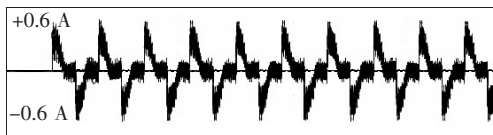
图4 相地电容 115\ \mu\text{F} 配网发生 15\ \text{k}\Omega 电阻接地的全锯齿波相地增量电流
