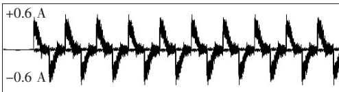
图 8 相地电容 30 \mu\text{F} 配网发生 15 k \Omega 电阻接地的 全锯齿波相地增量电流
