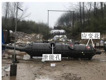
图 12 高压电缆接头保护装置爆前示意
