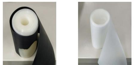
图 1 环切后的电缆试样
