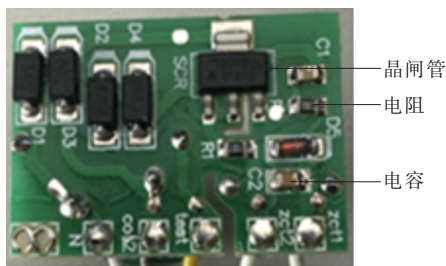
图 2 剩余电流动作断路器的中间环节
