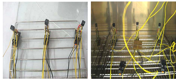
(a) 温升试验前 (b) 温升试验箱中
