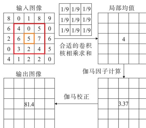
图2 自适应伽马校正处理过程
