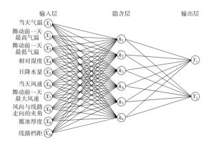
图2 BP神经网络导线舞动预警模型
