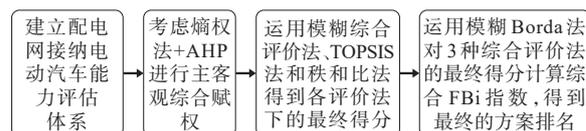
图3 配电网对EV接纳能力评估流程图
