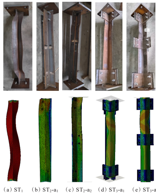
图6 试件破坏形态对比
