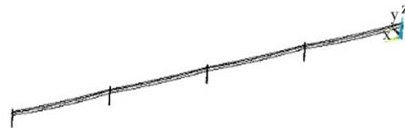
图 4 杆线结构有限元模型
