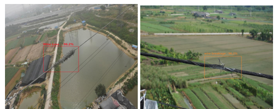
图 9 高像素导线缺陷识别效果
