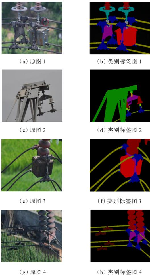
图 2 输电线路部分原图与其对应的类别标签
