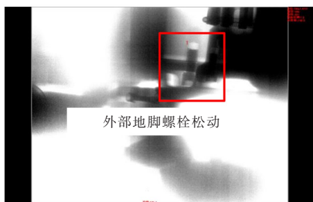
图10 存在外部地脚螺栓松动的GIS设备X射线成像示意
