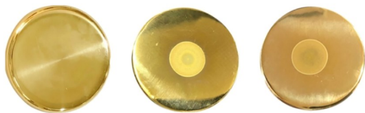
图22 不同 O_2 含量放电后的电极表面形貌(左:对照组;中:0% O_2 ;右:4% O_2 )
