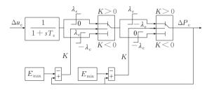
图 3 电网负荷频率控制中的电动汽车模型
