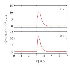
图8 EV1、EV2输出功率偏差曲线
