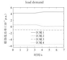
图7 负载需求变化时各区域注入联络线功率
