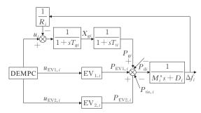
图4 包含EV的电网LFC框图
